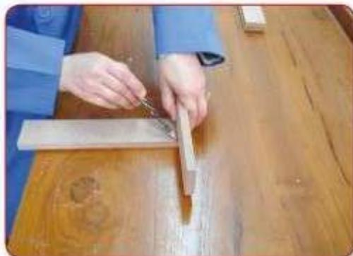
1 - تحديد سماكة الخشب المستخدم بالقلم الرصاص .
