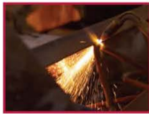
شكل (30) الطاقة الطاردة ، من تفاعل الإيثانين والأكسجين ، تكفي لأعمال اللحام.
