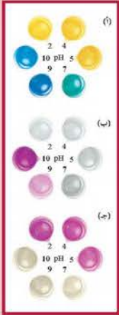
شكل (62) أداة تعادل الأحماض والقواعد تتسبب تغيرات الرقم الهيدروجيني pH في مدى معين. البرومولون الأزرق (أ) يتغير من اللون الأصفر إلى اللون الأزرق عند pH = 7 ، والفينولفثالين (ب) يتغير من عديم اللون إلى اللون الأرجواني عند pH = 9 ، أما الميثيل الأحمر (ج) فيعبر من اللون الأحمر إلى اللون الأصفر عند pH = 6 .
