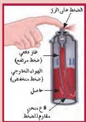
شكل (8) الفرق في الضغط بين داخل عبوة الرذاذ والدمان والهواء الخارجي هو أساس آلية عمل مثل هذه العبوات. كيف يكون الضغط داخل العبوة عندما لا تتمكن المادة المستخدمة في الدمان من الفرار والخروج منها؟
